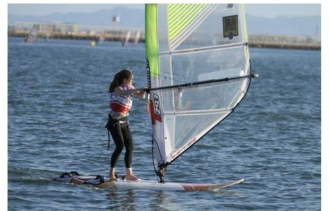
A diferencia de un velero, la vela o aparejo de una tabla de windsurf está articulado permitiendo su rotación libre alrededor de un sólo punto de unión con la tabla: el pie de mástil. Ello permite manipular el aparejo libremente en función de la dirección del viento y de la posición de la tabla con respecto a este último. El aparejo es manipulado por el windsurfista mediante la botavara.
